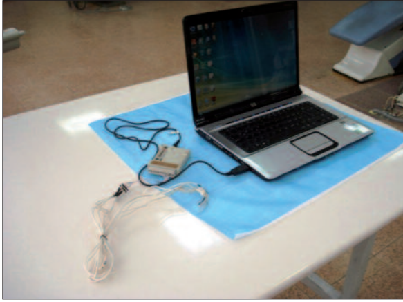
RESİM 4: Üzerinde algılayıcı bulunan plastik splintin veri kaydedici ve bilgisayar bağlantısı.
