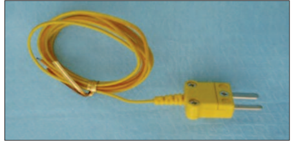
RESİM 2: K tipi termokupl. (Renkli hali için Bkz. http://dishekimligi.turkiyeklinikleri.com/ )
