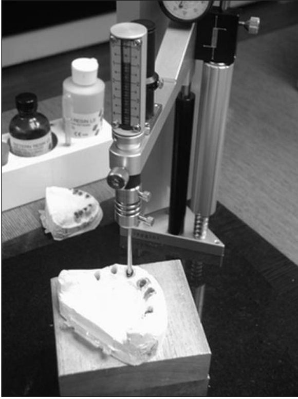
RESİM 9a: Bilgisayarda belirlenmiş konumlar bir freze makinesi yardımıyla alçı modellere implant analogları olarak olduğu gibi aktarılır.
