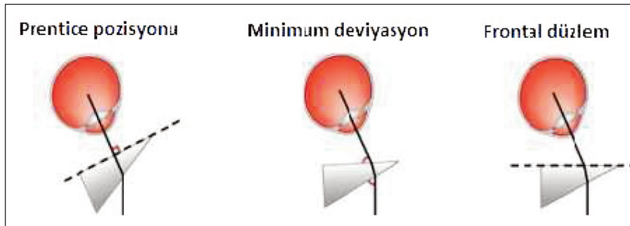
ŞEKİL 2: Prizmalar için 3 primer pozisyonun gösterimi. 4
