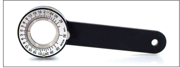
RESİM 1: Elde tutulan Risley prizmasının görünümü.
