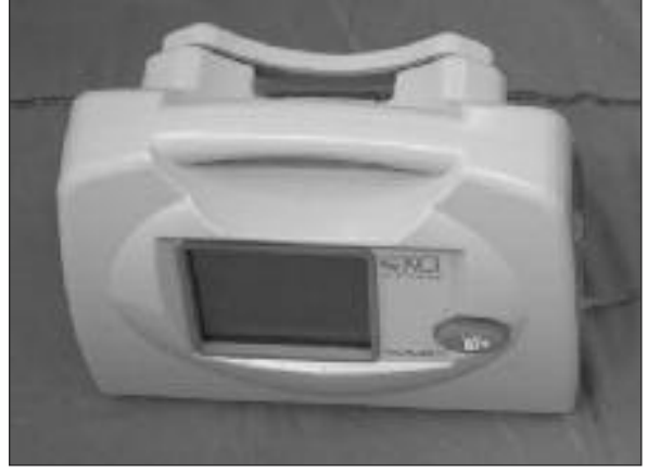
RESİM 2: Sürekli ya da aralıklı negatif basınç uygulayan ve bir rezervuar hazneye sahip pompa sistemi.
