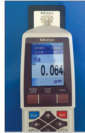
RESİM 2: Çalışmada kullanılan profilometre cihazı.
