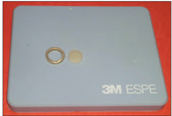
RESİM 1: Kullanılan metal kalıp ve elde edilen örnek.
