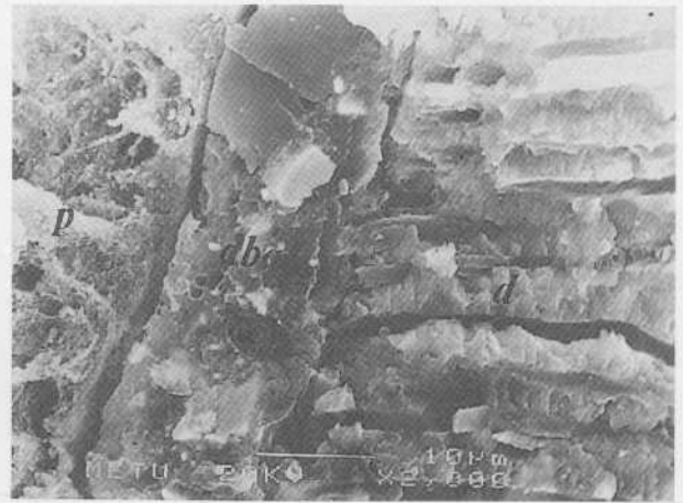
Resim 2. Resim 1'e ait bölgenin x2000 büyütmedeki görünüşünde dentin bonding ajan (dba) ve pat (p) izlenmekte.
