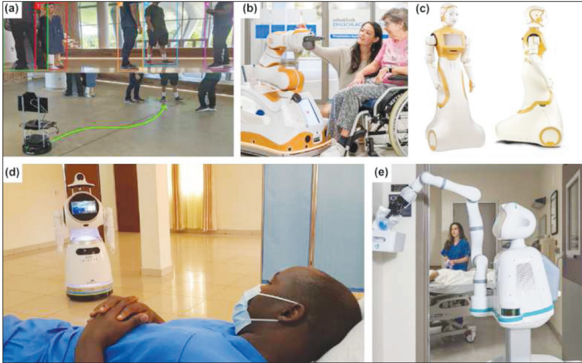
RESİM 9: Sosyal ve bakım robotlarına örnekler. (a) Bilgisayarla görme ve navigasyon yöntemlerini kullanarak sosyal mesafe izleme (Fotoğraf: Adarsh Jagan Sathyamoorthy). (b) HRI özelliklerine sahip Lio Robot. İsviçre'deki bir rehabilitasyon kliniğinde Lio ile etkileşime giren hasta ve personel (Fotoğraf: Justinas MiSeikis). (c) ARI (PAL Robotics) İnsansı Robot, daha etkili sosyal etkileşimi amaçlar (Fotoğraf: Sara Cooper). (d) Gösteri sırasında bir sağlık çalışanının ateşini kontrol eden Cruzr robotu (UBTECH Robotics). (e) Bir hastanede hastalara bakan Moxi (Diligent Robotics) (10. kaynaktan alınmıştır).
