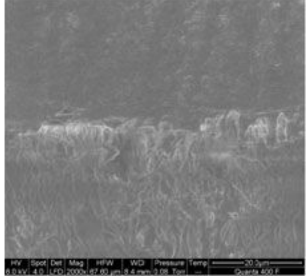
Resim 4. Pekabond'un Al 2 O 3 'li mineye bağlantısının taramalı elektron mikroskobundaki görüntüsü.
