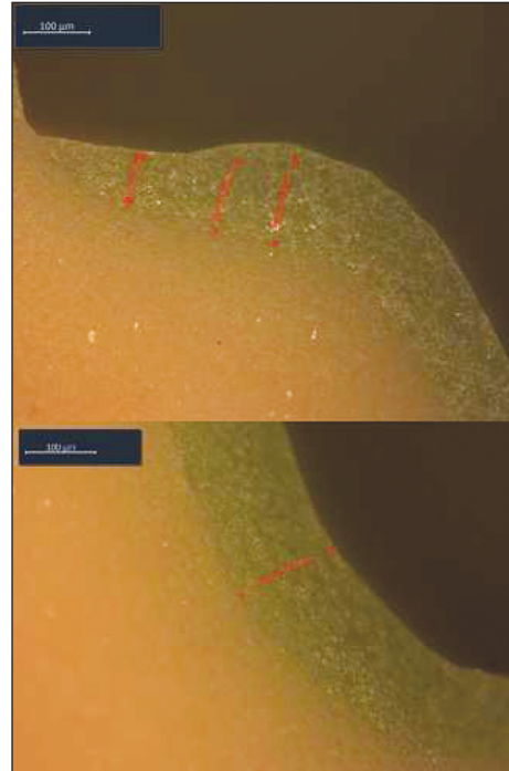
RESİM 7: Marjinal aralığa ait ölçümlerin ışık mikroskobu altında yapılması.
