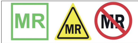
RESİM 1: Materyallerin manyetik rezonans görüntüleme güvenliği ile ilgili simgeler. Soldan sağa sırasıyla: Manyetik rezonans görüntüleme güvenilir, manyetik rezonans görüntüleme koşullu, manyetik rezonans görüntüleme tehlikeli.
