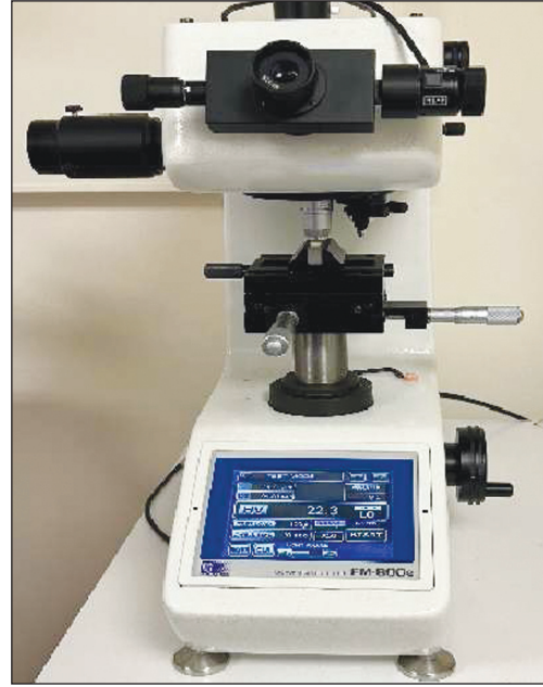
RESİM 2: Vickers sertlik cihazı.
