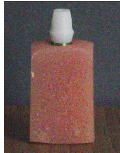
RESİM 1: Otopolimerizan akrilik rezin içerisine yerleştirilmiş implant analoğu ve standart zirkonya abutment (3,5 mm çapında ve 7,0 mm yüksekliğinde).
