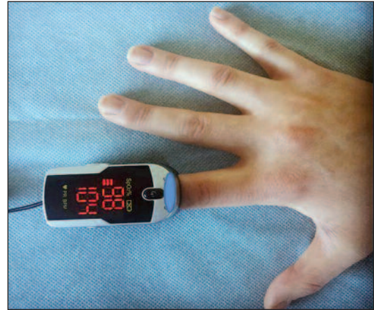
RESİM 2: Parmak probu nabız oksimetre.
