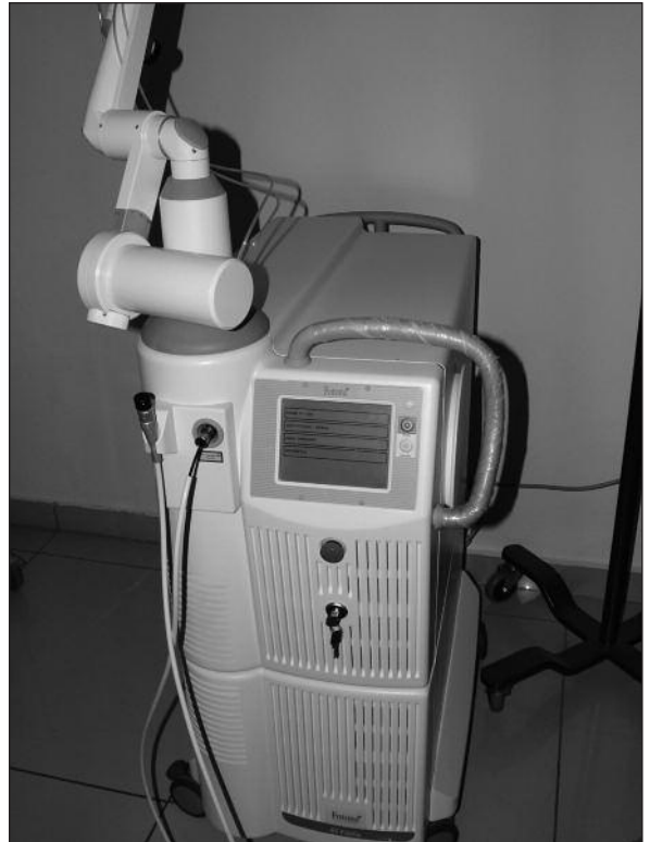
RESİM 2: Er:YAG-Nd:YAG ikili lazeri.
