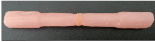
RESİM 1: Gerilme dayanımı testi için hazırlanmış bir örnek.
