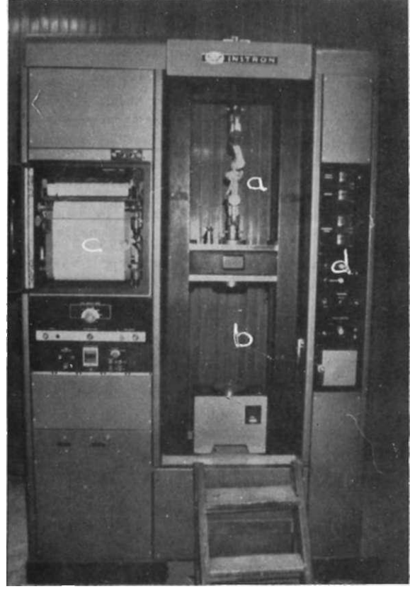
Şekil 1. Bu çalışmada kullanılan test cihazı, a) Çekme koparma, b) Sıkıştırma ezme. c) Osilograf. d) Yükleme oranı ile ilgili bölümler
