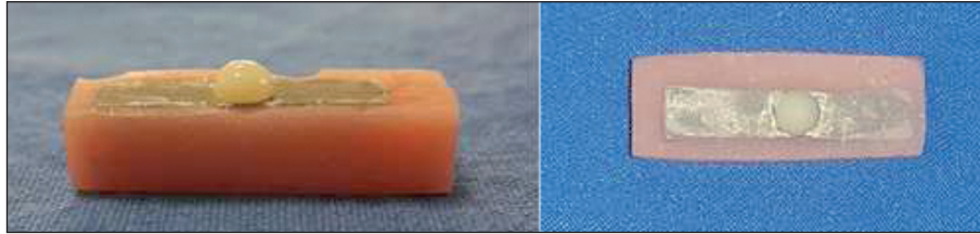
RESİM 4: Otopolimerizan akrilik rezin içerisine gömülmüş makaslama bağlanma dayanımı yapılacak örnekler üzerine uygulanan porselen tabakası.
