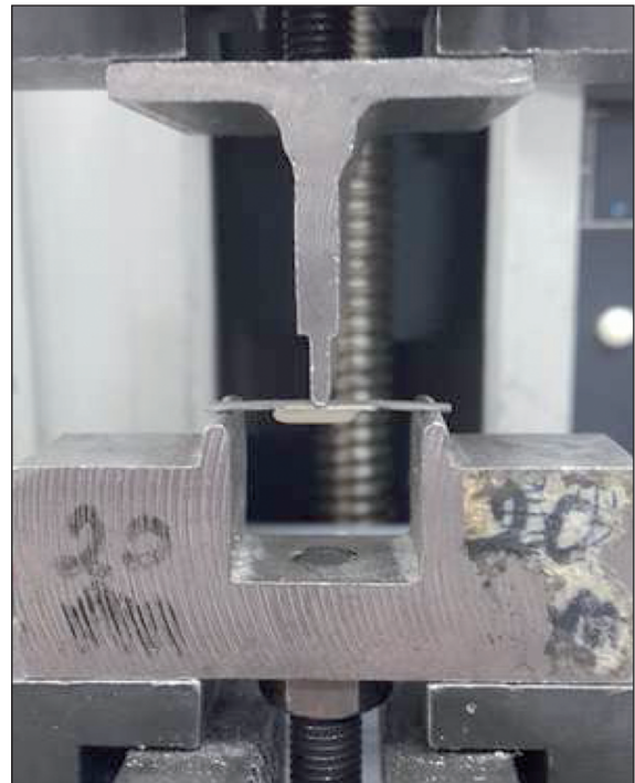
RESİM 5: Üç nokta bükme testi için hazırlanan test düzeneği.
